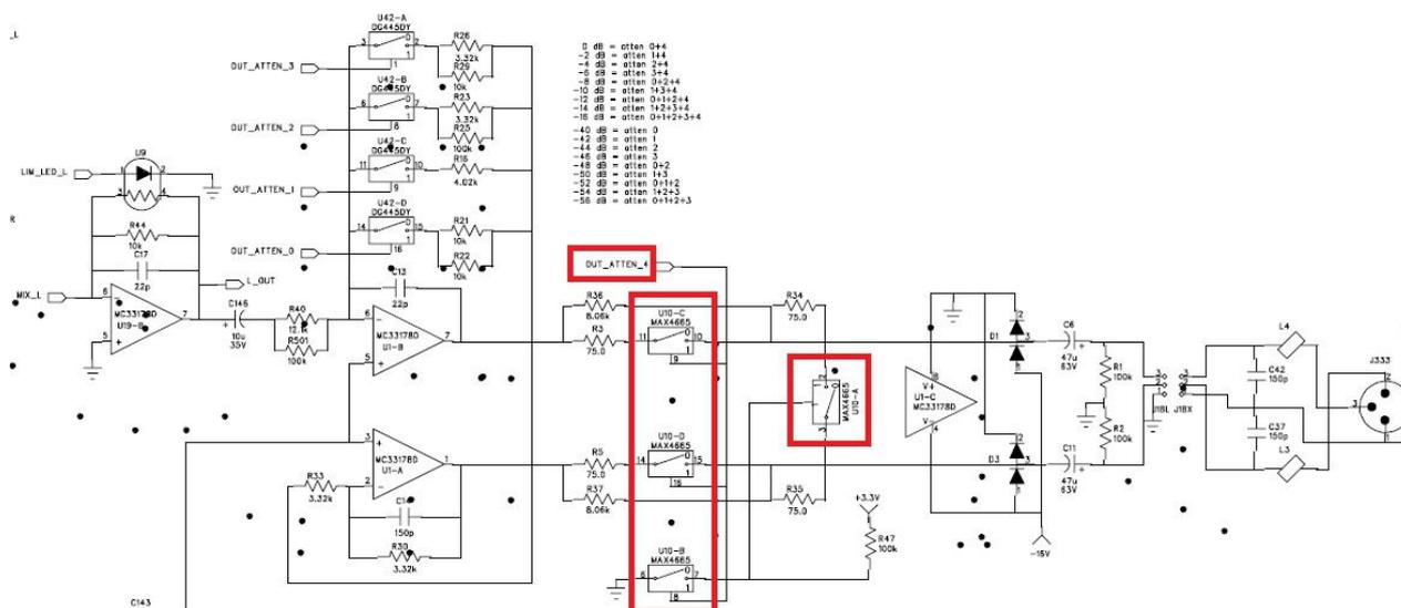
En fonction des résistances commutées par l'IC via le menu de la mixette, le niveau de sortie est atténué de valeurs fixes.
