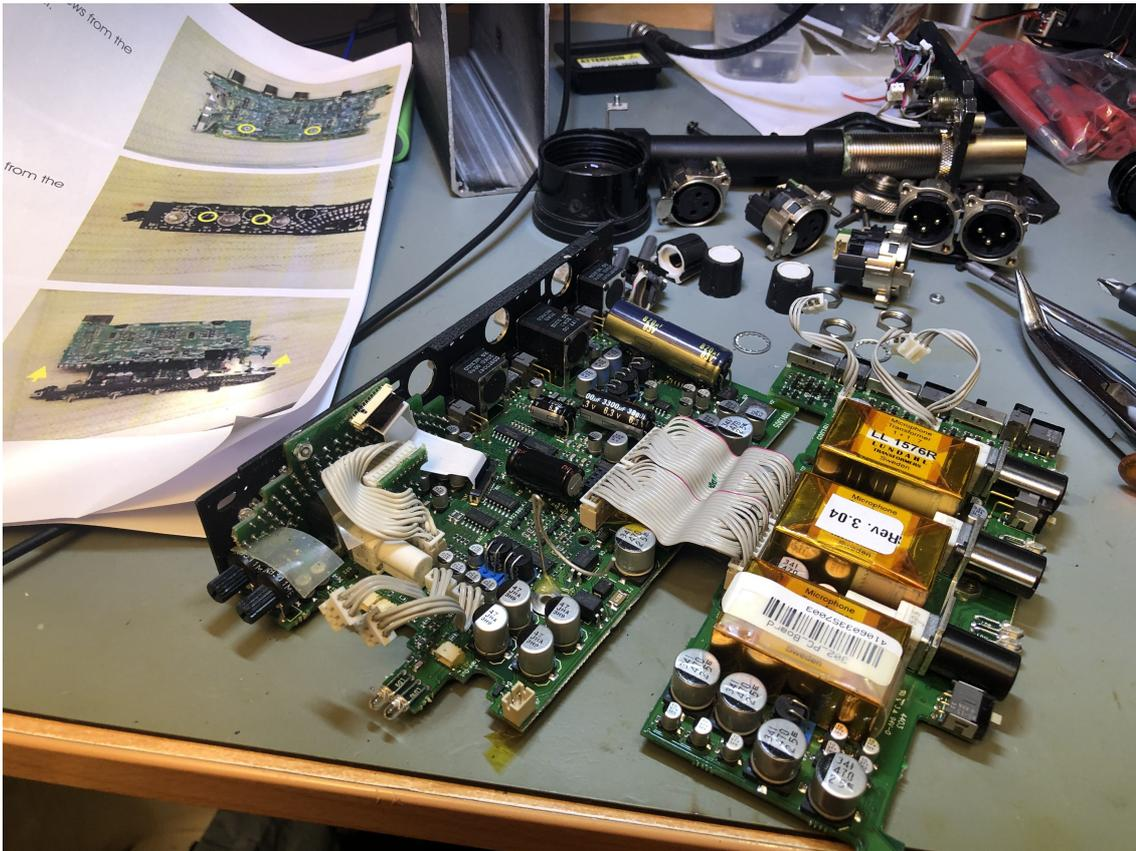
Mixette alimentée, je passe alors un doigt sur les circuits intégrés pour détecter si l'un d'entre eux est anormalement chaud. Il ne me faut que quelques secondes pour en identifier un.
