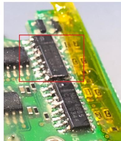
L'analyse du schéma élec montre que cet IC est localisé dans la fonction atténuateur de sortie, et n'est utilisé que pour la voie de gauche, et plus précisément, pour la partie des faibles atténuations, celle allant jusqu'à -16dB. Les atténuations plus fortes, celles entre -40 et -56 dB sont commandées par un autre IC du même type.
